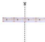
Technische Daten Noxion Naga LED-Streifen IP65 SMD2835/240 24V 16W/m 965 5M/10mm/25mm
