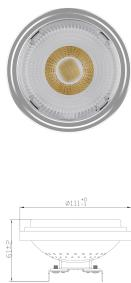
Technische Daten Noxion Lucent LED-Spot G53 AR111 7.3W 550lm 40D - 918-927 Dim To Warm | Höchste Farbwiedergabe - Dimmbar - Ersatz für 50W
