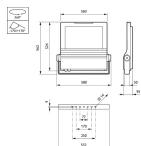
Technische Daten Philips Led-Scheinwerfer ClearFlood BVP650 Aluminium 70W 10680lm 72x22D - 740 Kaltweiß | IP66 - Asymmetrisch
