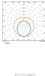
Technische Daten Ledvance LED Röhre T8 EM Performance (EM/Mains) Ultra Output 15.6W 2500lm - 865 Tageslichtweiß | 120cm - Ersatz Für 36W
