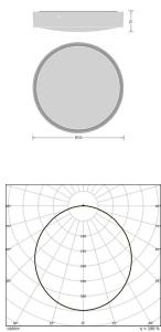
**Technische Daten Ledvance LED-Wand- und Deckenleuchte Rund Weiß 12.5-19.5W 1360-2230lm - 830-840 CCT | 312mm - IP65 - 3H Not**
