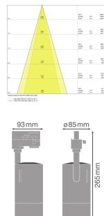
**Technische Daten Ledvance LED Schienenstrahler D85 Schwarz 25W 1500lm 15-55D - 840 Kaltweiß | Mechanical Zoom - Dimmbar**
