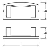
Technische Daten Ledvance LED Streifen Abschlusskappe für Profil PF04
