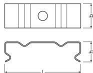
Technische Daten Ledvance LED Streifen Montage Halterung für für Profil PW01 | Metall
